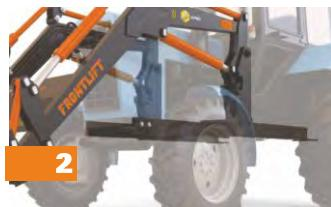
Крепление погрузчика осуществляется по всей длине рамы трактора с фиксацией в трех местах, обеспечивает равномерное распределение нагрузок на раму трактора.
