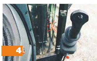
Возможна установка 2-х или 3-х координатного джойстика. При установке джойстика увеличивает производительность и высвобождается задняя пара гидравлики.
