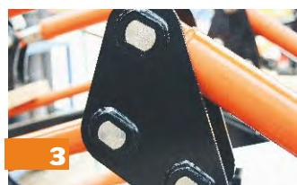
В узлах трения установлены полимерные втулки, что позволяет эксплуатировать погрузчик без обслуживания (ежемесячной смазки).
